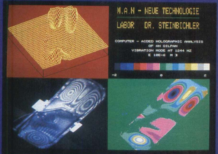
Das ist eine Holografie von einer Ölwanne. Der Computer kann dieses Bild in verschiedene Grafiken umsetzen.
