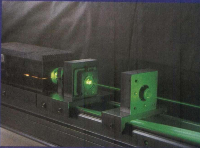
Dieser frequenzverdoppelte YAG-Laser der Firma Baasel-Lasertechnik wurde zum Fotografieren freigelegt.
