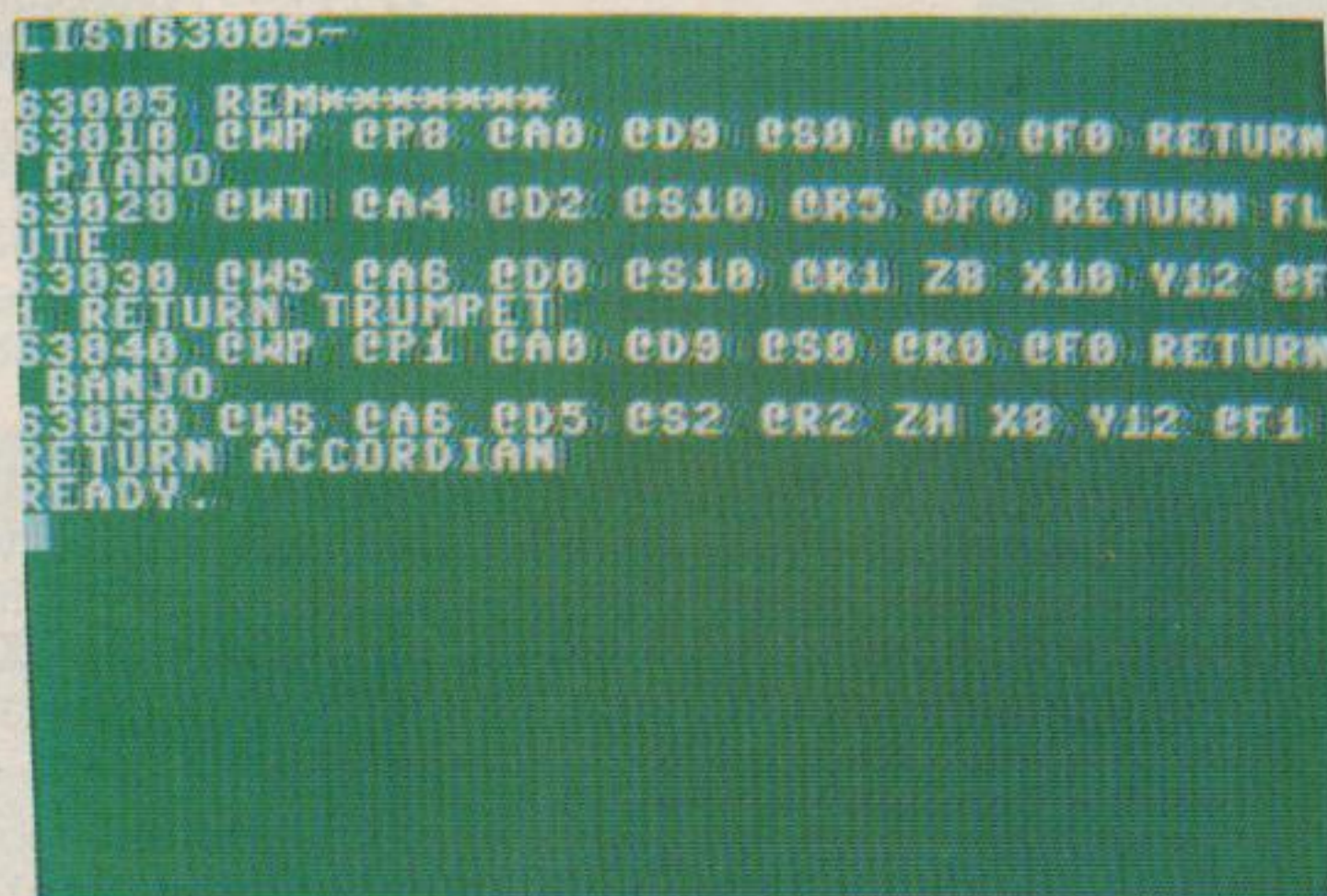
Bild 3. Nützlich bei der Fehlersuche: Die »Trace-Funktion« zeigt jeweils einen Step der Komposition in allen seinen Parametern
