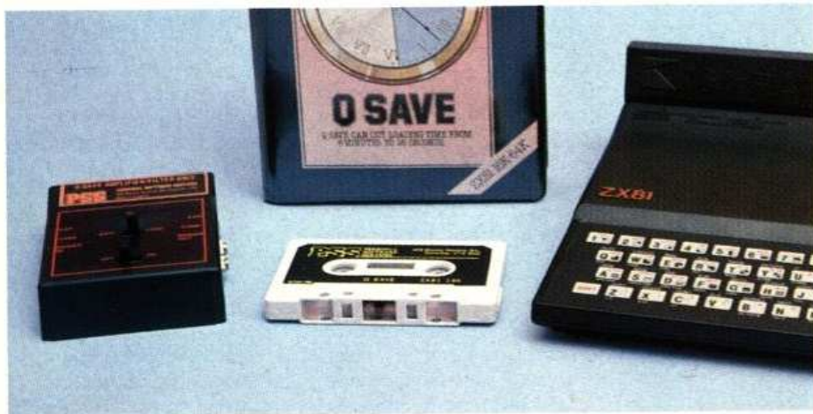
Bild 1. Die wichtigsten Bestandteile des Q-Save sind ein kleines schwarzes Kästchen mit der Hardware und eine Kassette mit dem zugehörigen Maschinencode-Programm
