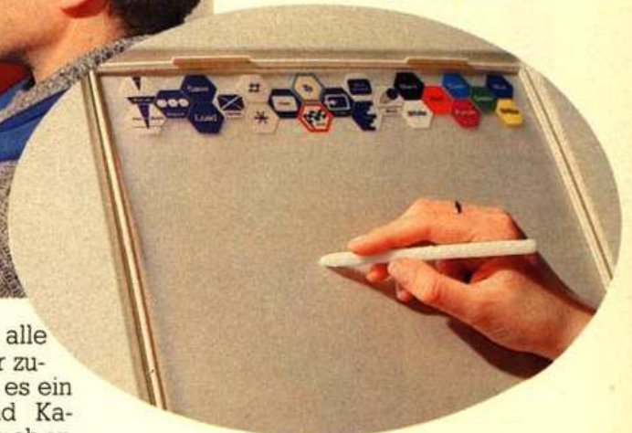
Bild 3. Mit 21 Symbolen auf der Overlay-Folie kann man das Malprogramm bedienen und das PowerPad als Zeichengerät nutzen
