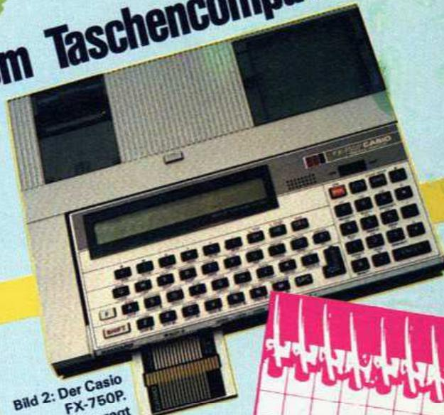
Bild 2: Der Casio FX-750P. Unten links ragt eine »RAM-Card« heraus
