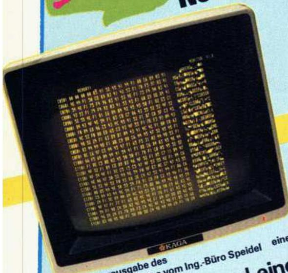
Bild 1: Monitorausgabe des PC-1500-Videointerfaces vom Ing.-Büro Speidel
