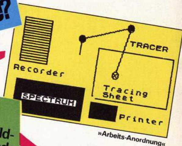
Die Funktionsweise des Tracers ist recht einfach: In dem Doppelgelenkarm eines Storchenschnabels sind zwei Potentiometer untergebracht, mit deren Hilfe der Computer die jeweilige Position des Zeichenkopfes (bezogen auf den fest montierten Teil des Tracers) ermittelt. Dieser Punkt wird auf dem Bildschirm durch den Cursor angezeigt.
