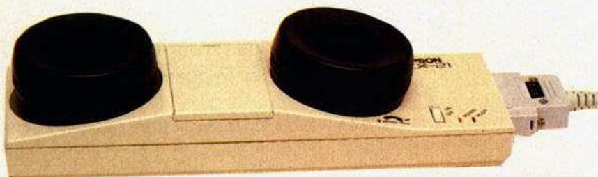
Mit dem Akustikkoppler in eine neue Welt: Der Epson CX-21 Ausgabe 9/September 1984
