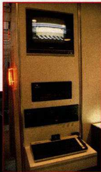
A-D-Wandler macht CP464 zum Speicheroszilloskop und Synthesizer
