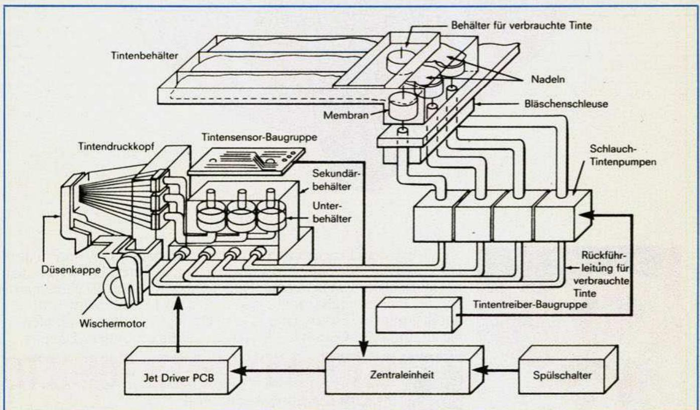
Schematischer Aufbau eines Farb-Tintendruckermechanismus
