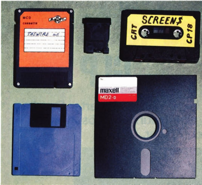
Der Größe nach: Microdrive- Cartridge, C- Kassette, MCD- Diskette (3 Zoll) 3 1/2-Zoll-Diskette, 5 1/4-Zoll-Diskette
