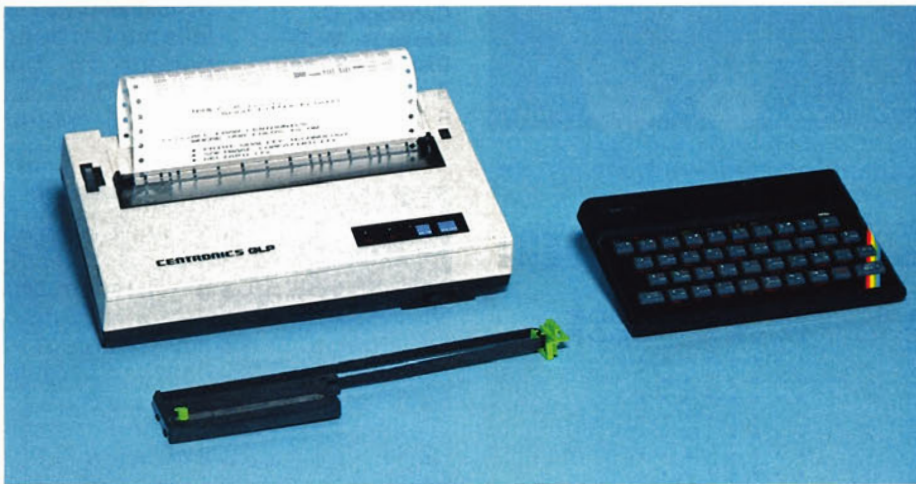
Zum Größenvergleich: Centronics GLP neben dem Spectrum. Am Farbband ist deutlich der »Fingerschutz« zu erkennen.
