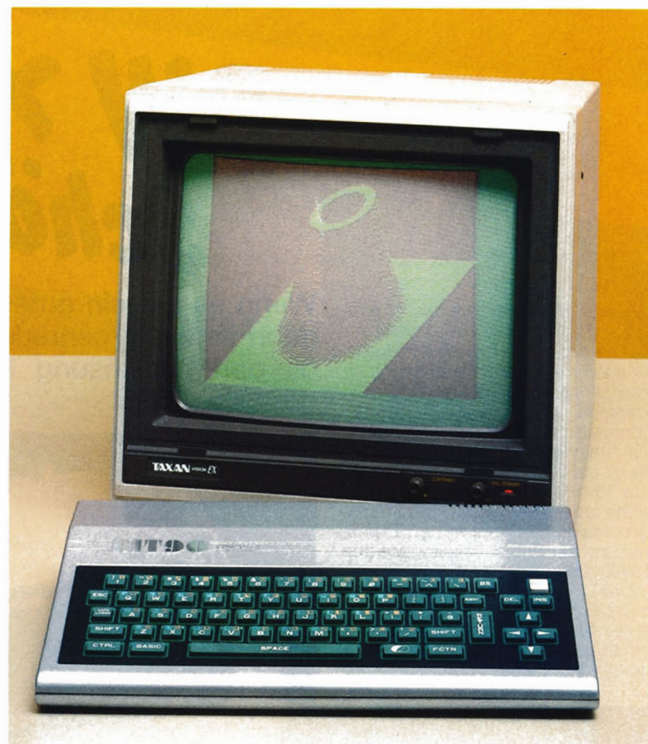
Der metallische Glanz täuscht: Das Gehäuse des Bit-90 ist aus Kunststoff
