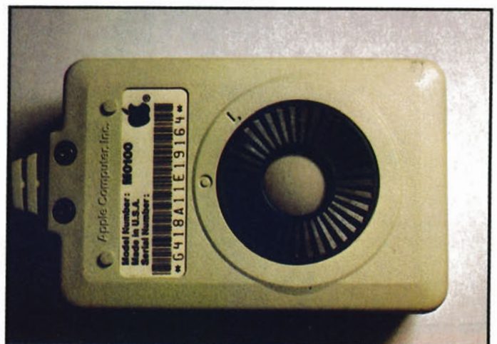
Bild 1. Die Maus (Unterseite) und ihr Bein. Die Rollkugel läßt sich ohne weiteres nach Drehen des Ringes herausnehmen.
