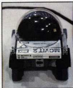
Einen Roboterzweig »Movit 2«, der mit einer Compactkassette gesteuert wird, zeigte OWI. Das Programm kann mit MSX-Computern zusammengestellt und aufgezeichnet werden
