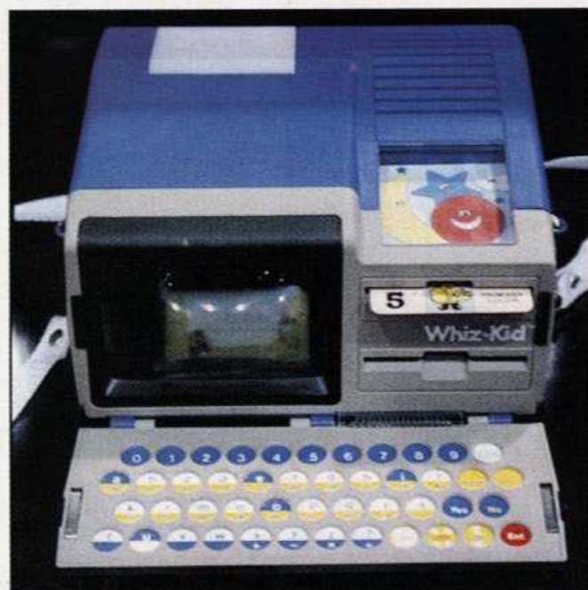
V-tech zeigte »Whizkid«, den »PC für Kinder«, ein witziges Lehrspielzeug mit Lochkartenprogrammen und einem farbigen LC-Display als Bildschirm
