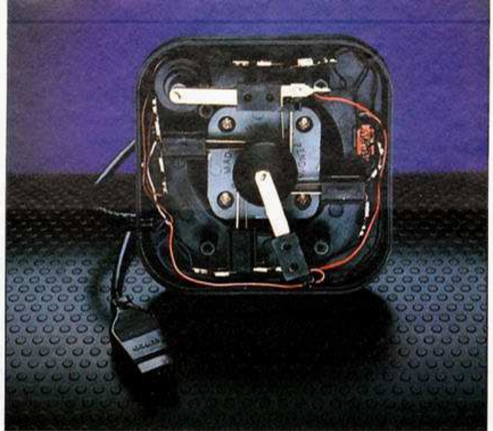
Bild 2. Geöffneter Joystick mit Federkontakten
