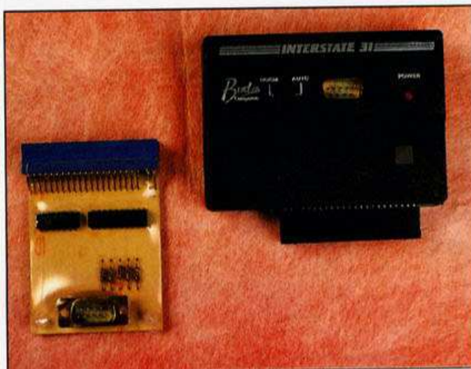
Eigenbau- und Billig-Interface nach Kempston-Norm
