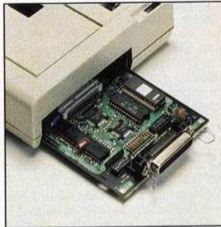
Die Schnittstellen sind beim Okimate 20 leicht auszutauschen — sie werden einfach eingesteckt
