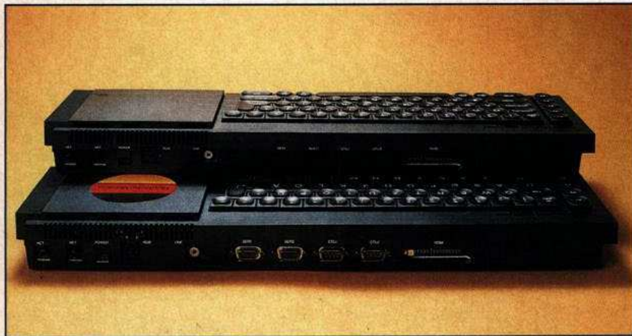
Der deutsche QL bietet im Gegensatz zum britischen Vorbild für Joysticks und Drucker 9polige Normsteckverbindungen
