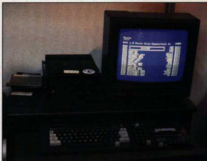
Das Data Media-Doppellaufwerk für den Schneider bietet satte 1,6 MByte Speicherkapazität
