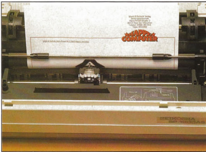
Selbst seitenweiser »Schwarzdruck« läßt den kleinen aber zähen Druckkopf des SP-1000 mit seinen 9 Nadeln kalt
