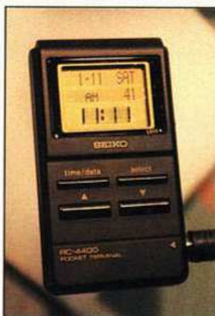
Datenspeicher für die Tasche: RC-4400 von Seiko wird über Kabel vom C 64 mit Daten versorgt
