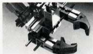
Greifhand mit symmetrischem Spindeltrieb.
