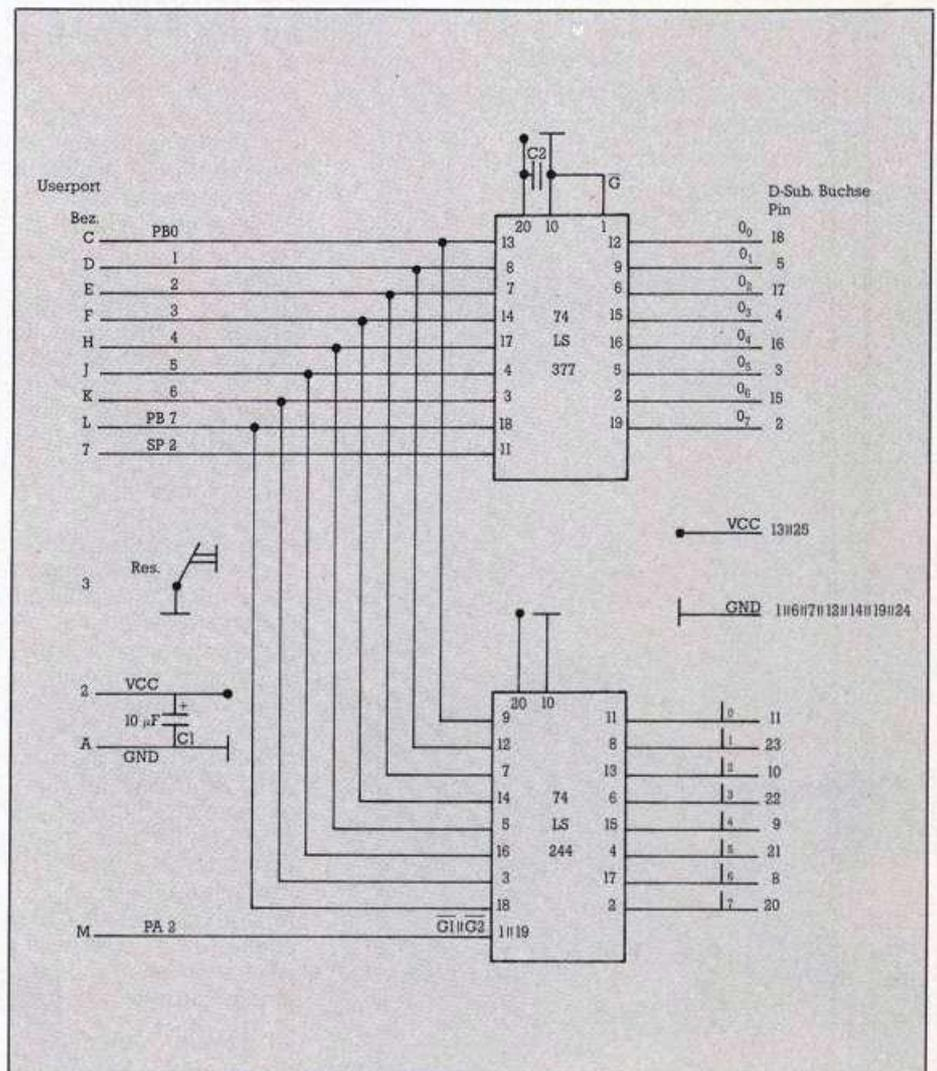
Bild 1. Schaltplan für die Hardware-Bastelei »Userport-Verdoppelung«
