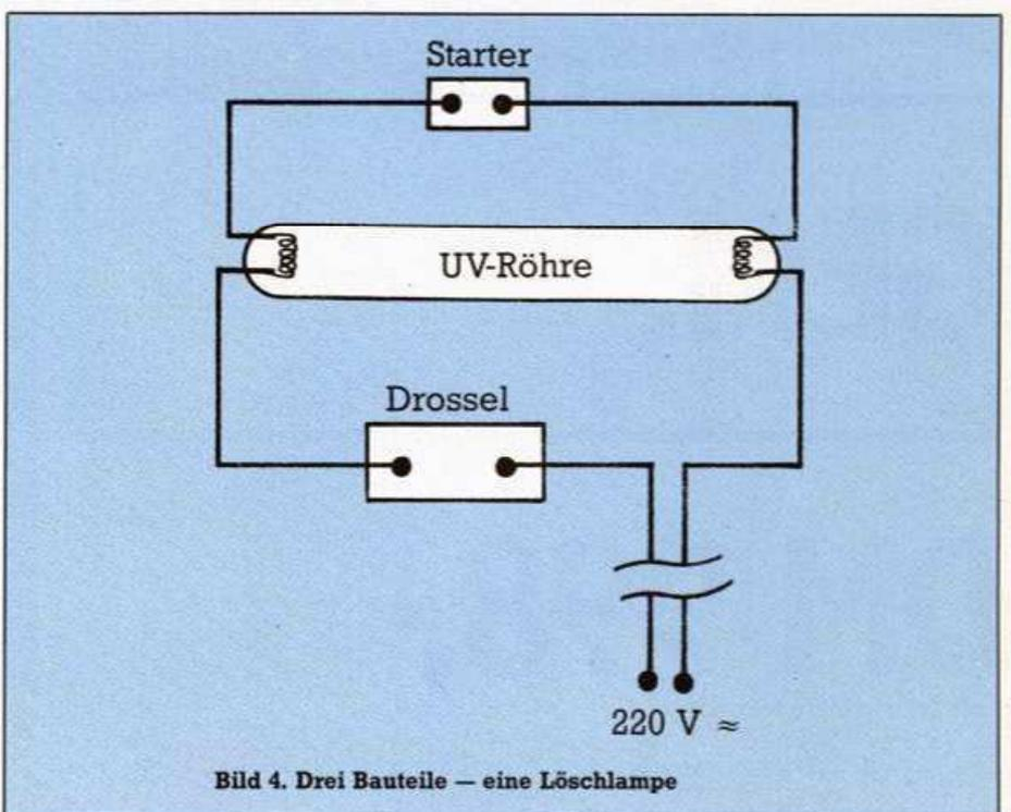
lung ist zwar geeignet die Pigmentbildung der Haut anzuregen, nicht aber ein EPROM zu löschen. Mehr Erfolg versprechen spezielle Löschlampen, die Licht mit einer Wellenlänge von zirka 2500 Angström ausstrahlen. Damit bestrahlt man das Quarzfenster aus einer Entfernung von bis zu fünf Zentimetern.
