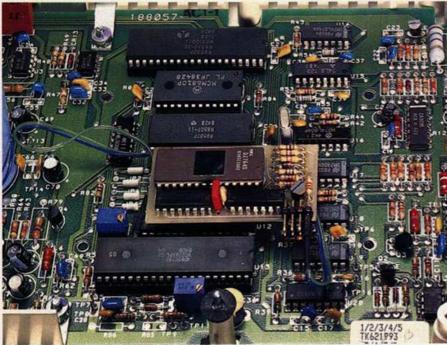
Platinausschnitt: So wird »1050 Turbo« in das Laufwerk eingebaut
