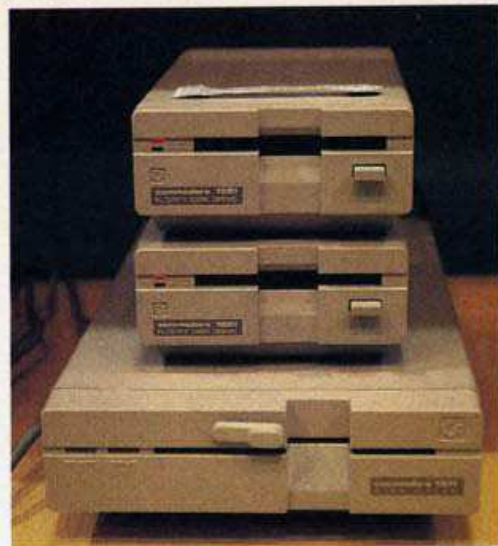
Das 3 1/2-Zoll-Laufwerk für den C 64. Es präsentiert sich im modernen Design des C 128-Look und paßt sich der 1571, die hier als Ständer dient, harmonisch an.
