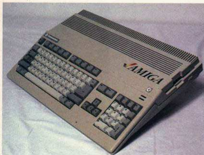
Hier ist das eingebaute Laufwerk des Amiga 500 gut zu sehen
