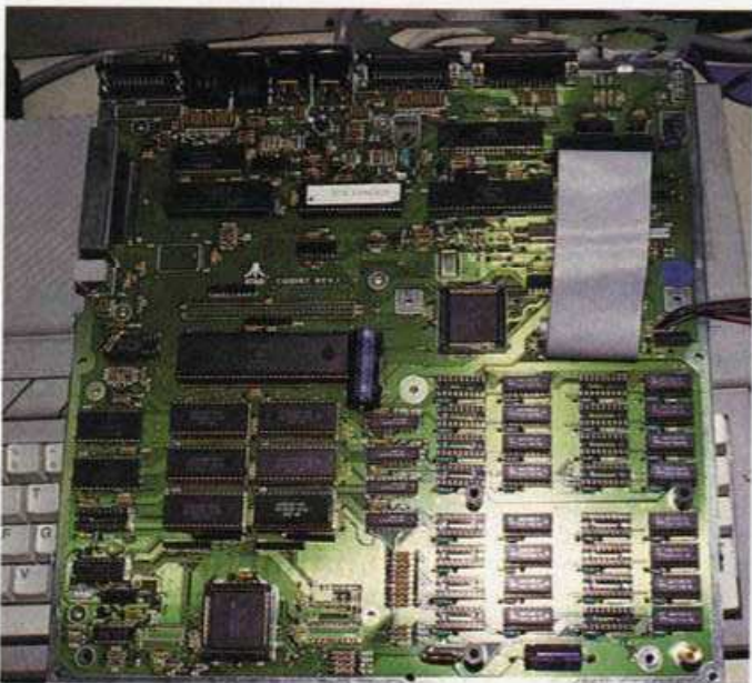
Freier Platz für den Blitter: die Platine des Mega ST
