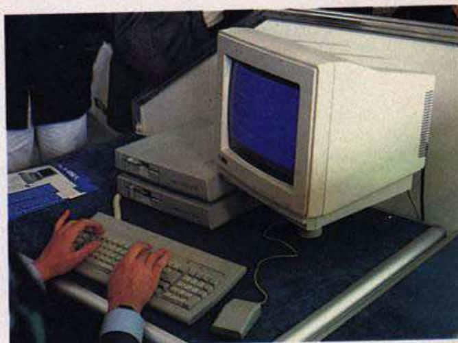
Bild 3. Auch der Atari PC hat die geringen Abmessungen von 33 x 32 x 9 cm. Steht der Monitor direkt auf der Zentraleinheit, braucht der PC kaum Platz.
