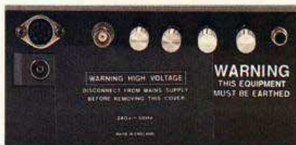
Bild 2. Auf der Rückseite des Screenvision sind die Regler und Buchsen
