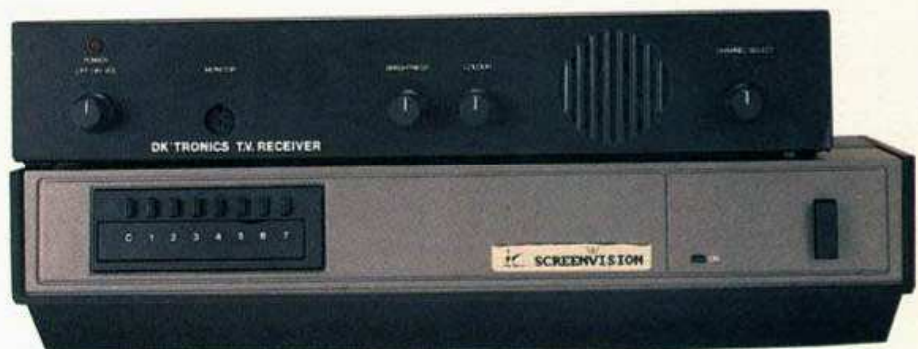
Bild 1. Schon die äußerlichen Unterschiede zwischen dem Screenvision- (unten) und dem dk'tronics-Fernseh-Tuner (oben) sind offensichtlich
