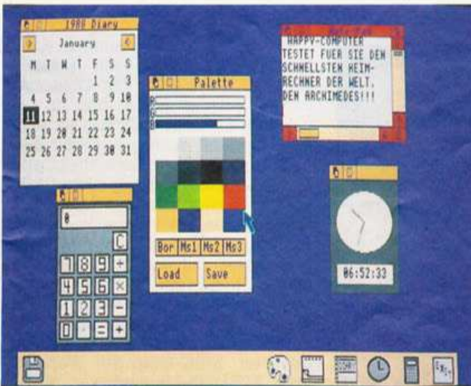
Die Benutzeroberfläche des Archimedes ist in Basic programmiert, trotzdem arbeitet sie atemberaubend schnell
