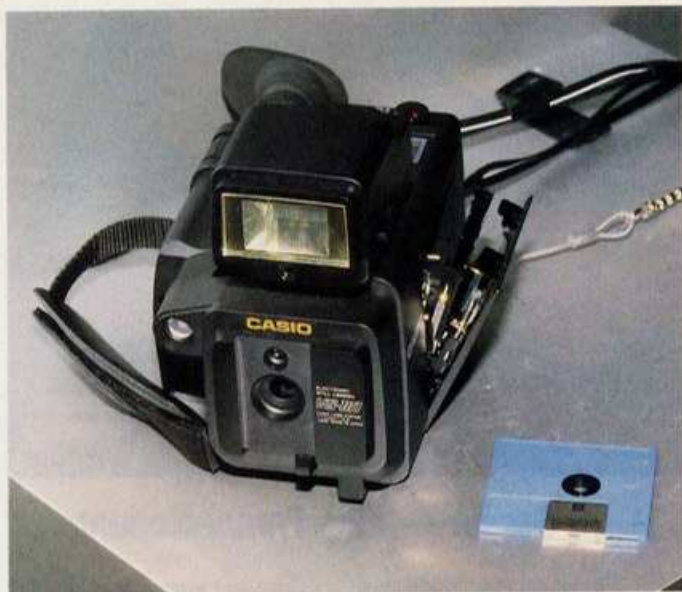
Diese Kamera speichert bis zu 50 Fotos auf 2-Zoll-Disketten, die nur halb so groß wie 3,5-Zoll-Disketten sind
