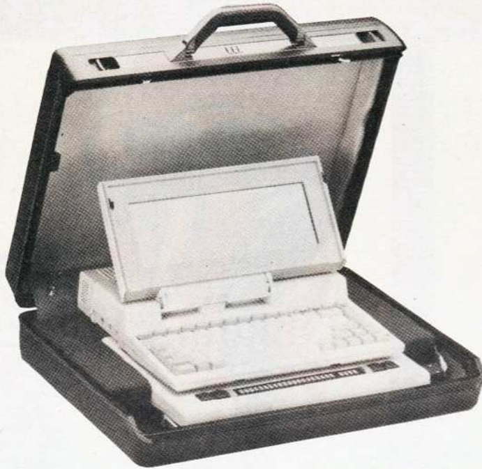
Als tragbares System mit Braille-Ausgabe-Zeile eignet sich dieser Laptop besonders für Blinde
