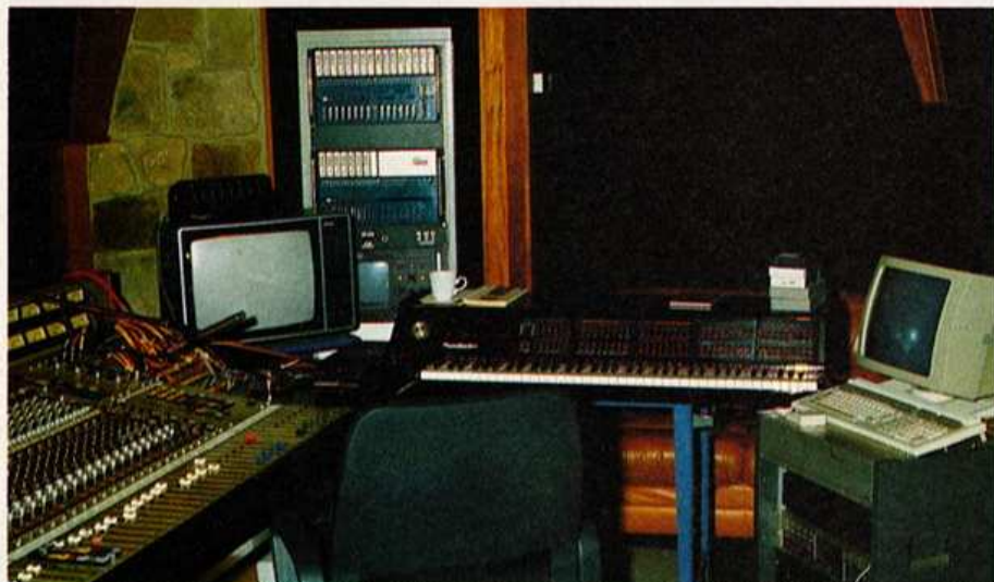
Man braucht das Computer-Terminal im Prinzip gar nicht, denn das Synclavier läßt sich über die 128 Tastschalter bedienen, von denen jeder 5fach belegt ist.
