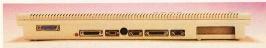
Die Anschlüsse des Euro PC im Überblick. Rechts die Öffnung für die Erweiterungskarte
