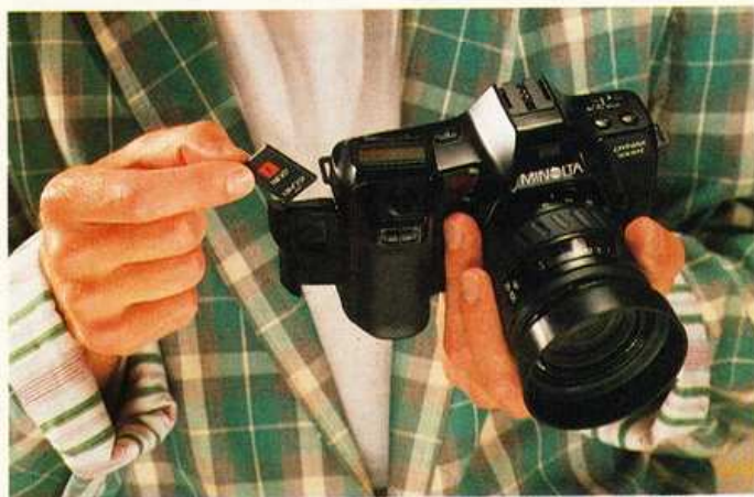
Die Dynax 7000i arbeitet mit zusätzlichen Chipkarten, wie ein Computer mit ROM-Modulen.
