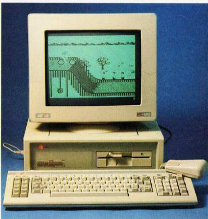
Bild 2. Der einzige 16-Biter ist der Amstrad PC 1512. Man merkt's an der hohen Rechengeschwindigkeit.
