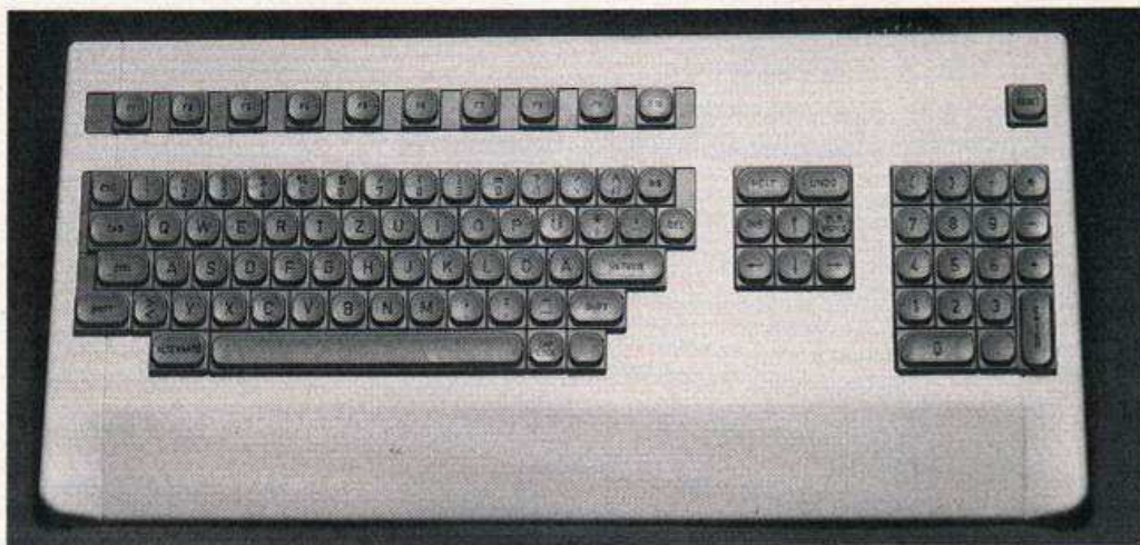
Die MTST-Tastatur wird mit hochwertigen Industrie-Tasten geliefert
