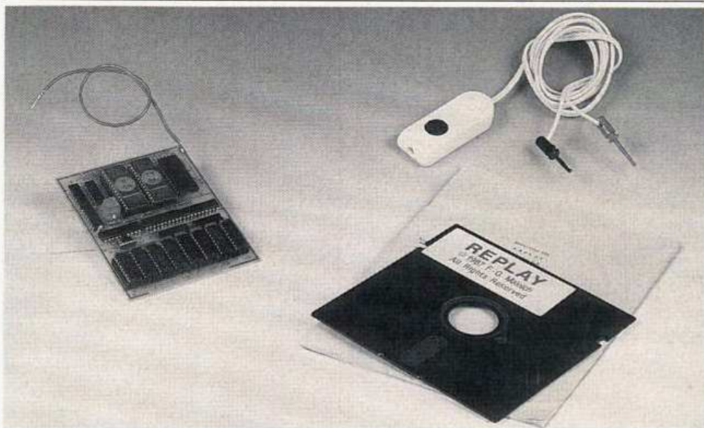
Der Turbo-Freezer (links) ist im Gegensatz zu Replay eine reine Hardware-Lösung
