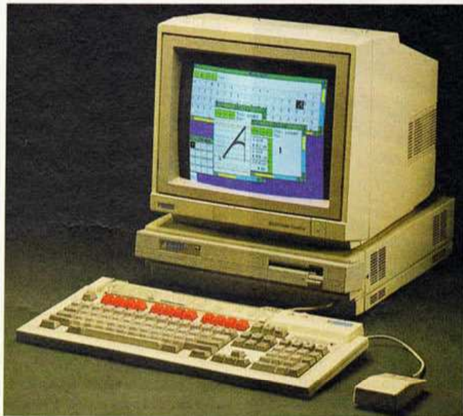
Geschwindigkeit ist beim Archimedes von Acorn Trumpf. Sein besonders schneller RISC-Prozessor macht ihn zum derzeit schnellsten Heimcomputer.
