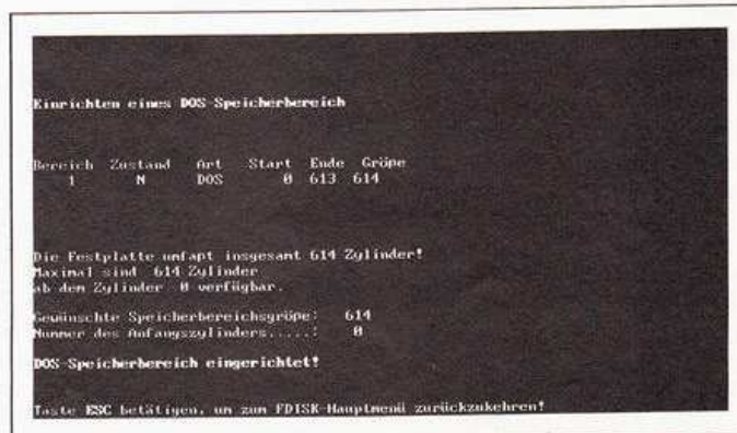
Bild 14. Nachdem die Festplatte eingerichtet wurde (hier mit den gesamten vorhandenen 614 Zylindern der ST 225), muß der Computer neu gebootet werden
