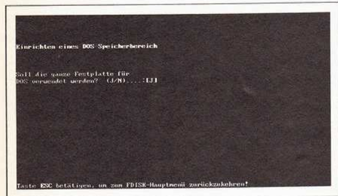
Bild 13. FDISK erfragt, ob die gesamte Festplatte für MS-DOS verwendet werden soll. Die Festplatte kann auch unterteilt und mit einem weiteren Betriebssystem bespielt werden.
