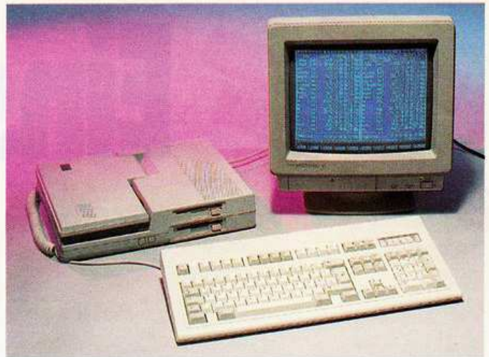
Mit abgesetzter Zusatz-Tastatur und CGA-Farbmonitor wird aus dem Anra-Laptop ein vollwertiger PC
