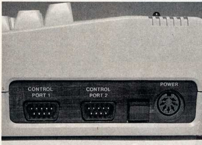
Zwei Joystick-Ports und der Anschluß fürs Netzteil
