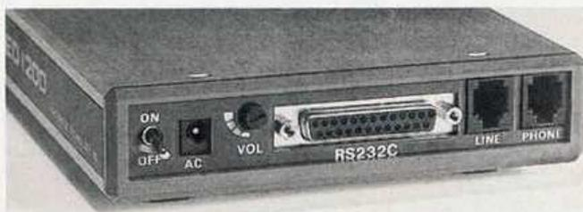
Ein Modem muß direkt an die Telefondose angeschlossen werden. Dafür läuft die Datenübertragung störungsfreier und in der Regel schneller als beim Akustikkoppler.
