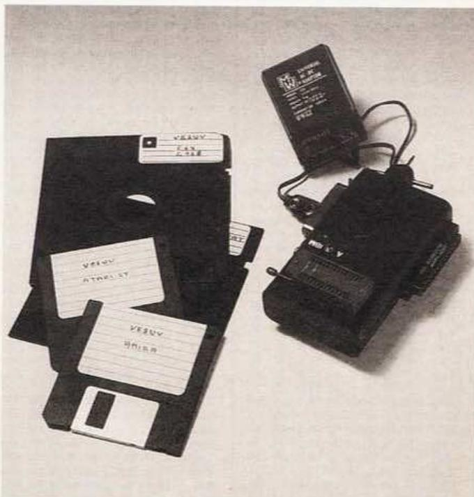
**Netzteil und Treiber-Software für C 64, ST, PC und Amiga gehören zum Lieferumfang des Vesuv-EPROMers**
