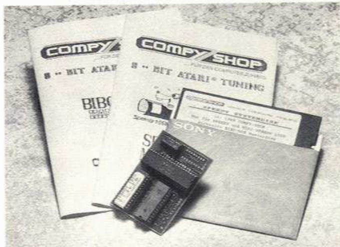
Mini-Speedy besitzt ein eigenes RAM für schnelle Disketten-Zugriffe. Unsere Version hatte das BIBO-DOS im ROM.
