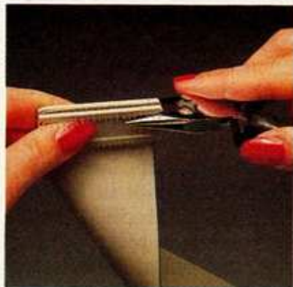
Die Stecker sollten mit Hilfe von Zange oder Klemme an den Kabelenden zusammengedrückt werden
