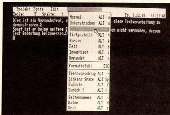
"Documentum" bietet vielfältige Funktionen zur Schriftgestaltung. Diese werden jedoch als Steuer-Sequenzen in den Text eingefügt
