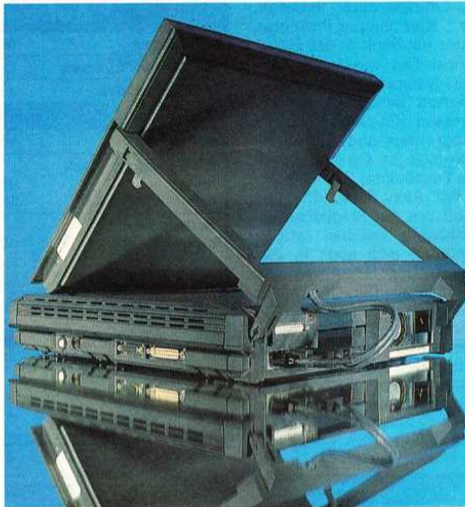
Von hinten sieht man die Schnittstellen des Golfs: Maus-Port, Anschluß für externes Laufwerk, RS232, parallele Schnittstelle, VGA-Grafik-Adapter und Reset-Taster.
