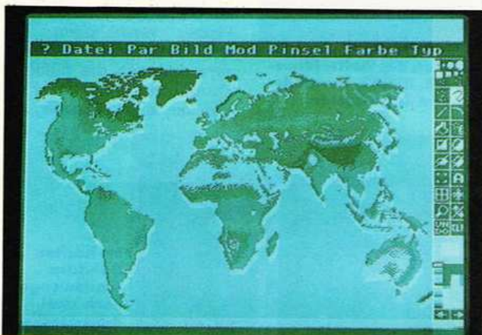
Das gute LC-Display stellt VGA-Grafik bis 640 x 480 Bildpunkte dar. Streifen bei großen Kontrasten sind aus technischen Gründen noch nicht vermeidbar.
