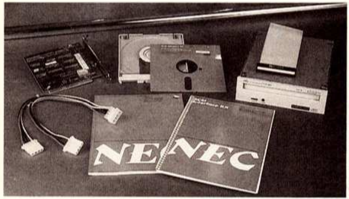
NEC offeriert ein komplettes CD-Einbau-Kit für rund 2000 Mark. Es paßt in verschiedene Computertypen.
