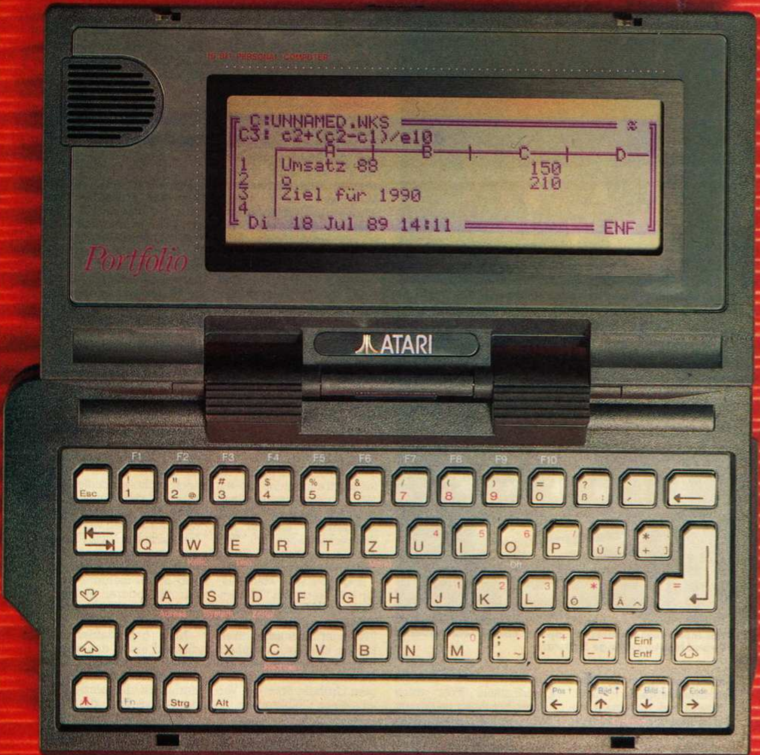
Der Atari Portfolio in Originalgröße. Der vollwertige PC ist etwas schmaler als eine DIN-A4-Seite.
