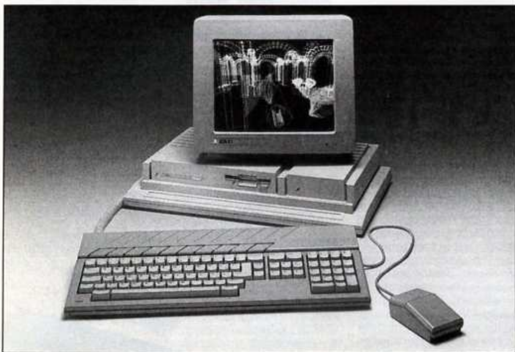
Die 32-Bit-Produktlinie von Atari unterscheidet sich schon äußerlich von den ST-Computern. Im Gehäuse hat sogar eine Festplatte Platz.
