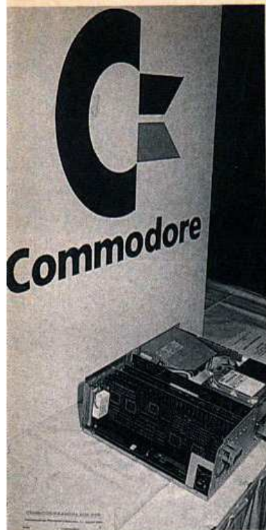
Der A 2500: mit Erweiterungskarten vollgestopft
