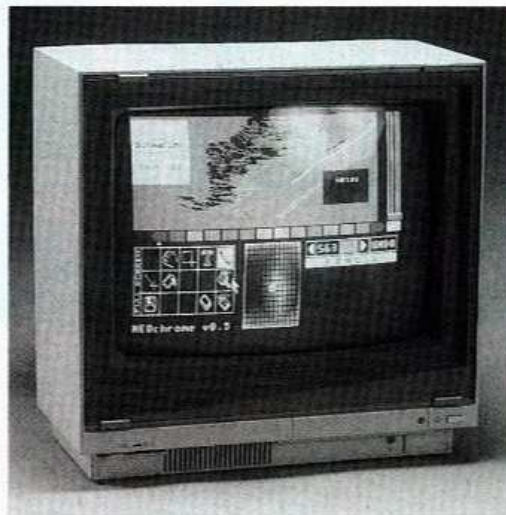
Auch Monitore haben nur eine begrenzte Lebenserwartung. Achten Sie auf die Schärfe des Bildes und eventuell Einbrennsuren auf dem Schirm.
