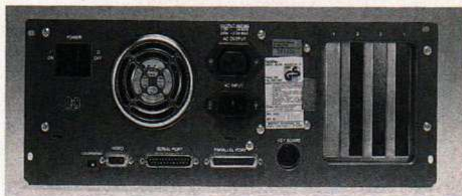
Vorbildlich beim Sanyo: Schnittstellen auf der Hauptplatine und freie Steckplätze
