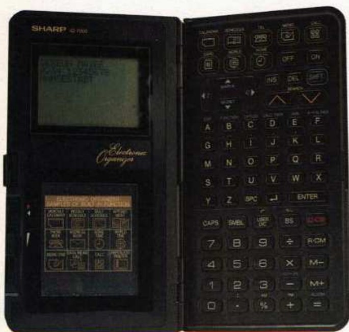
Der Sharp IQ-7000 ist bis auf 96 KByte ausbaubar und leichter zu bedienen als sein Konkurrent
