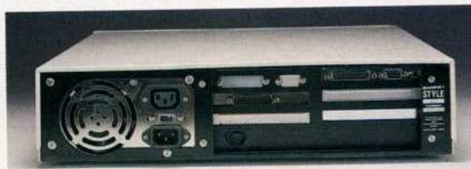
Unpraktisch: Weil fast alle Steckplätze des Quadral bereits belegt sind, kann man den AT kaum erweitern
