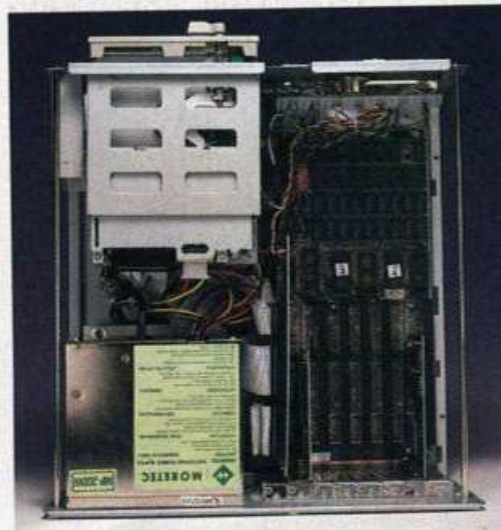
Der Silicon-AT ist sauber verdrahtet und bietet reichlich Platz für Erweiterungskarten
