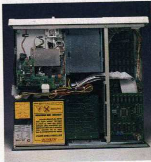
Viel zu eng sitzen die einzelnen Komponenten im Quadral-AT nebeneinander und provozieren Hitzestaus
