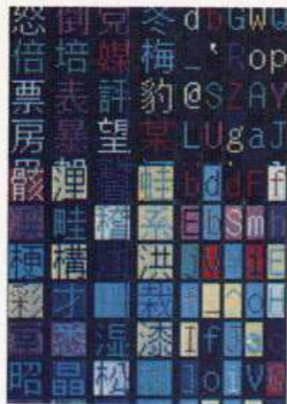
Die einzelnen LC-Zellen sind schon fast mit bloßem Auge erkennbar
