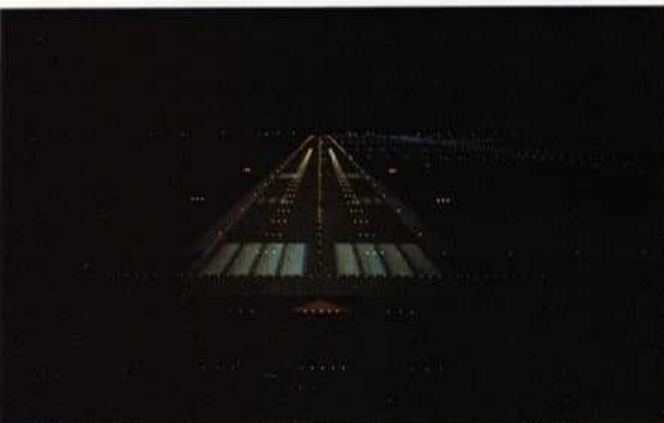
... und zur nächtlichen Stunde betrachtet. Der Computer kann bei Bedarf auch einen Ausfall der Landebahnbefeuerung simulieren.
