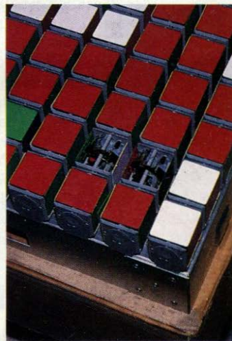
Aus über 100000 solcher Würfeln setzt sich das Bild der Wand zusammen; eine Art elektronisches Mosaik
