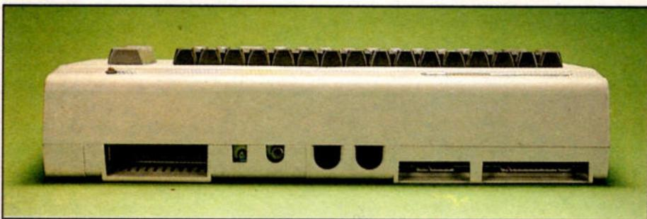
Bild 2. Universelle Schnittstellen auf der Rückseite des C64
