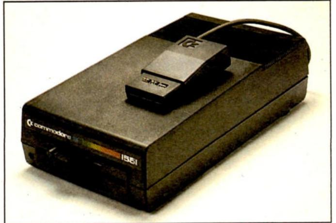
Bild 2. Schneller Massenspeicher: VC 1551
