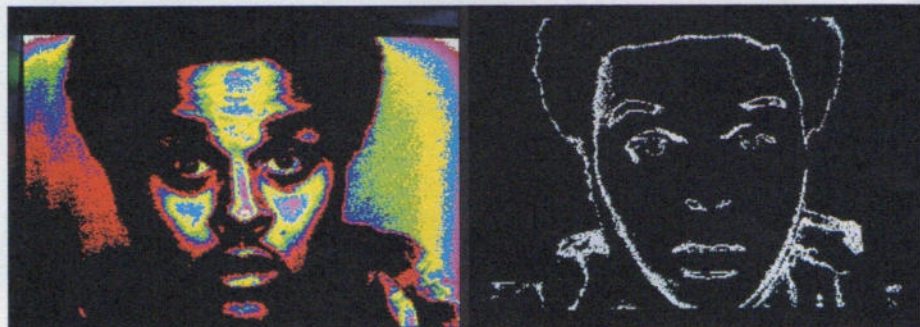
Bild 8. Durch Farben (links) oder Äquidensiten (rechts) heben sich Strukturen ab
