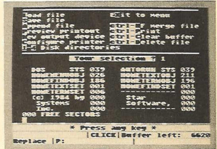
Bild 8. Ein Hauptmenü von »HomeText«. Jede Funktion läßt sich mit nur einer Taste aufrufen.
