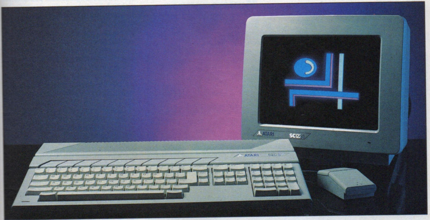
Zentraleinheit und Tastatur sind beim Atari ST in einem Gehäuse zusammengefaßt
