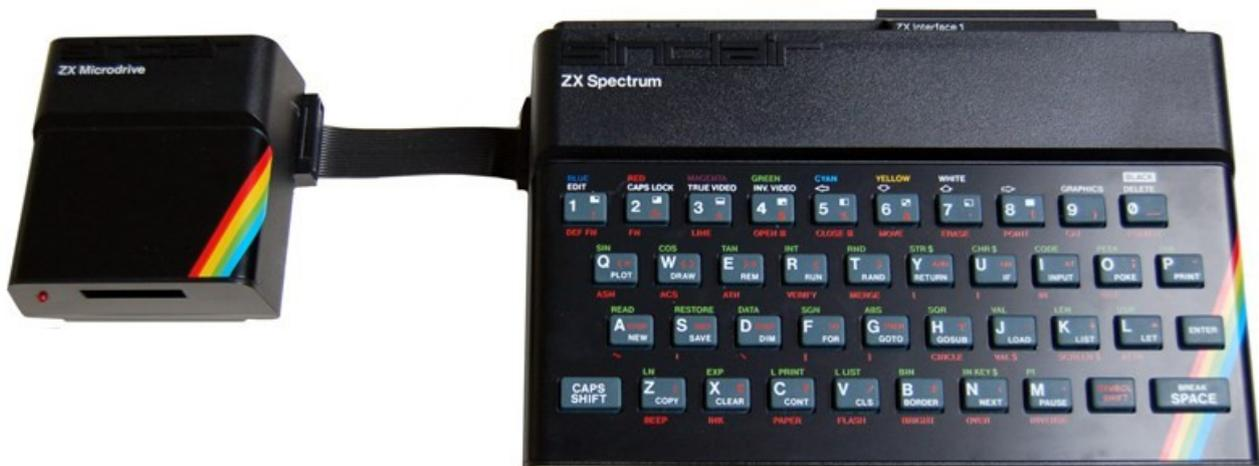
Abbildung 38 - Sinclair Spectrum mit ZX Interface 1 und ZX Microdrive.<sup>225</sup>
