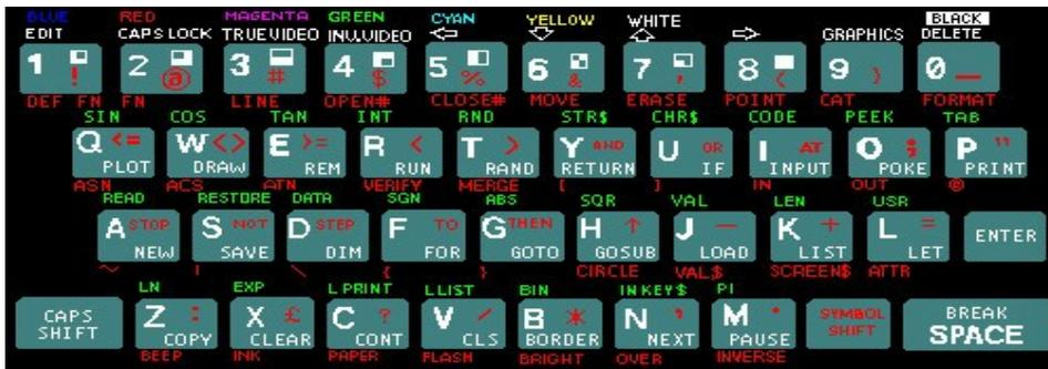
Abbildung 37 - Die fünffache Tastaturbelegung des Sinclair Spectrum.
