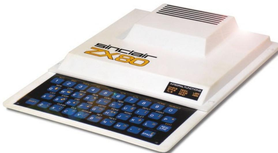
Abbildung 19 - Der Sinclair ZX80 mit Folientastatur.<sup>105</sup>
