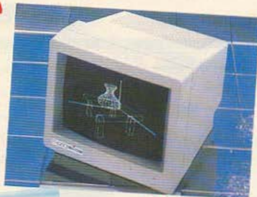
ΜΟΝΤΕΛΟ 3010 COMPOSITE MONOCHROME MONITOR 12 ΙΝΤΣΩΝ ΔΙΑΚΡΙΤΙΚΟΤΗΤΑ: 800 dots x 262 lines ΔΥΝΑΤΟΤΗΤΑ DISPLAY: 2000 χαρακτήρες
