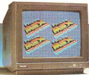
Έγχρωμη οθόνη 14" τύπου VS000 με δυνατότητα 25 γραμμών επί 80 χαρακτήρες, έξοδο ήχου 0,3 WATT, εκκρίνει 390x285 PIXELS.
