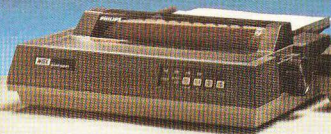
Εκτυπωτής VW 0020,80 στηλών με ταχύτητα 37 CPS, μήτρα χαρακτήρα 8x8, πλάτος 10".
