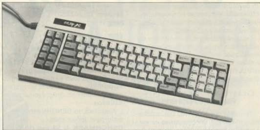
Το πληκτρολόγιο του EAZY PC. Τα CAPS LOCK και NUM LOCK έχουν ενδεικτικά leds λειτουργίας.
