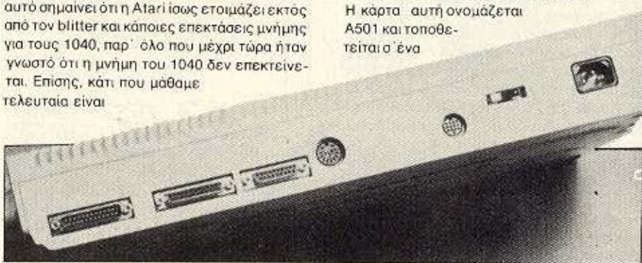
Οι υποδοχές του 1040: RS232, centronics, hard disk, disk drive, monitor. Να σημειωθεί ότι οι STFM έχουν ακριβώς τις ίδιες θύρες.
