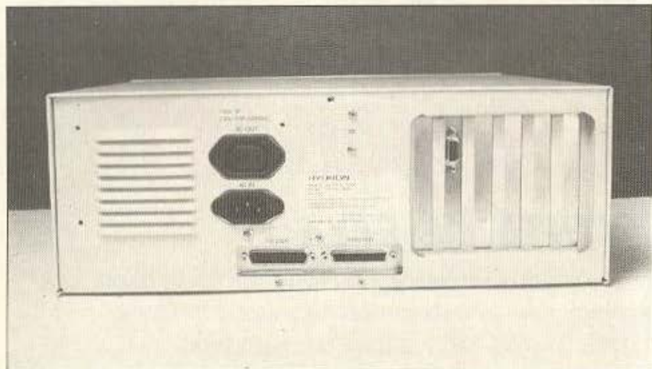
Η πίσω όψη με τα 6 slots, τη θύρα RS-232 και την centronics.
