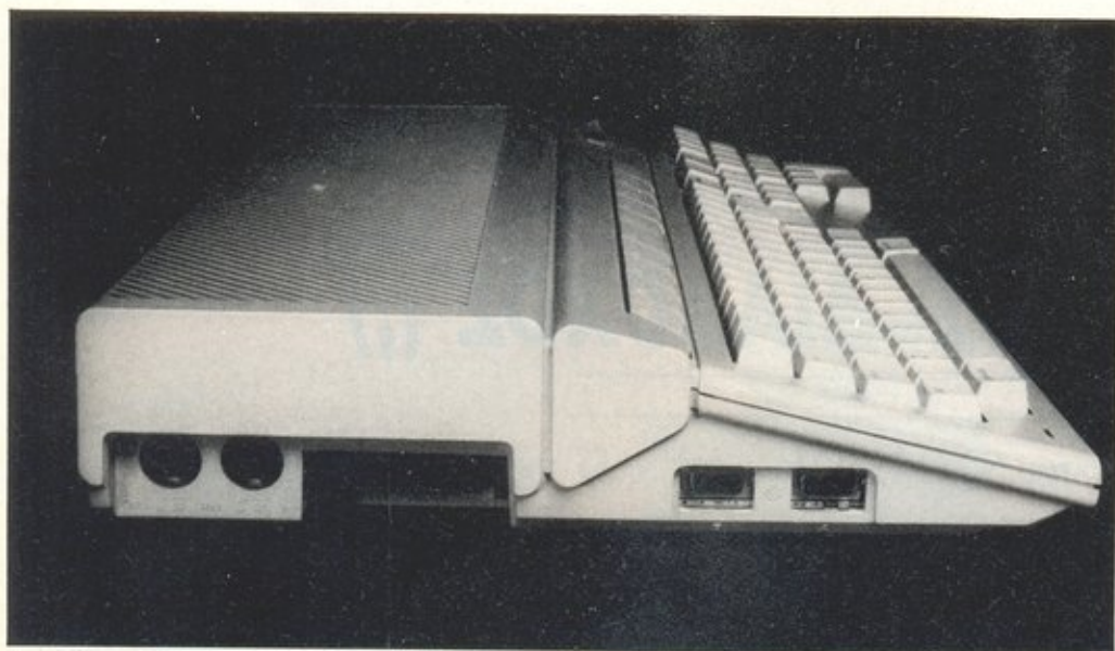
Midi in, Midi out, θύρα γενικής επέκτασης και οι δύο θηλυκές εισοδοί για joysticks.
