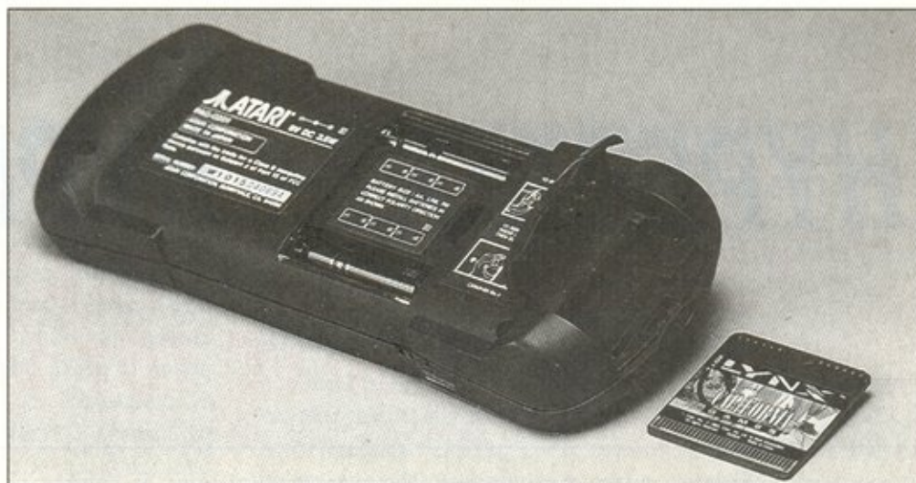
Πίσω άποψη του μηχανήματος. Εκεί βρίσκεται το "τεπόζιτο" ενέργειας και ο θάλαμος των cartridges.
