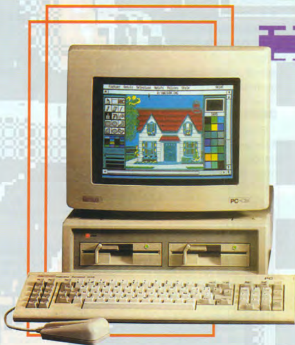
Η Amstrad εισχώρησε στην αγορά των IBM/PC συμβατών με τον 1512. Στα πρότυπα του CPC κυκλοφόρησε με ενσωματωμένα drives και οθόνη.
