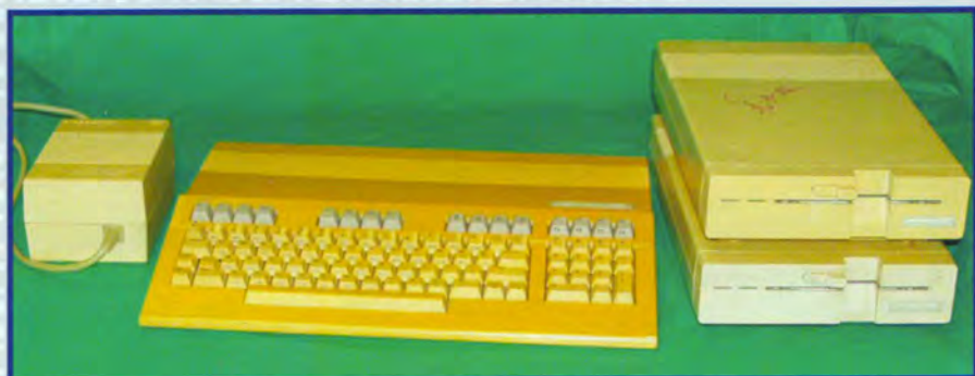
Ένα ολοκληρωμένο σύστημα Commodore 128. Διακρίνεται το ογκώδες τροφοδοτικό του, στο κέντρο ο ίδιος ο 128 και δεξιά δύο disk drives διπλής όψης.
